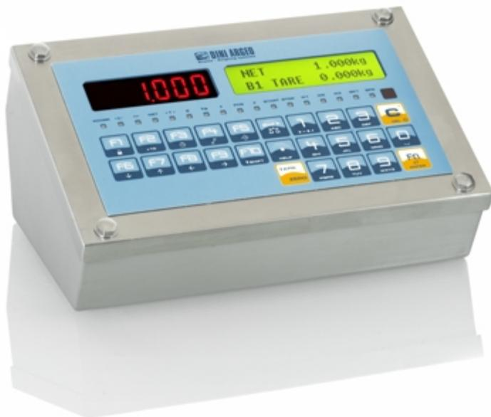
Wäge-Indikator mit Edelstahl-Gehäuse IP65, geeignet für explosionsgefährdete Bereiche, ATEX-Kennzeichnung: ATEX II 3G Ex nR IIC T6 Gc X für Gase ATEX II 3D Ex tc IIIC T135°C Dc IP68 X für Staubpartikel.
