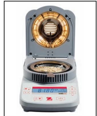
Das OHAUS-Modell MB23 ist mit einem Infrarot-Heizelement ausgestattet, während das Modell MB25 Halogen-Technologie einsetzt.
