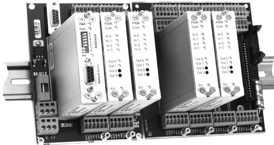
Beispiel für Typ MCS-64 mit 4 Kanälen und Profibus-Gateway
