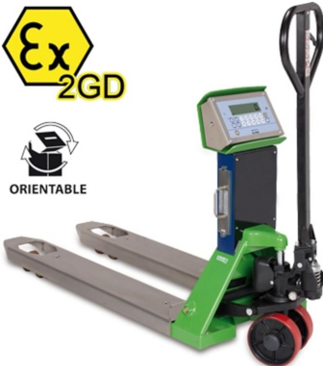
Gabelhubwagen mit Waagenfunktion, geeignet für den Einsatz in explosionsgefährdeten Bereichen (ZONEN 1 und 21 & 2 und 22), ATEX-Kennzeichnung Ex II 2GD IIB T4 T197°C X. Die Lastaufnahme über 4 ATEX-zertifizierte Wägezellen garantiert optimale Wägeregebnisse in allen Betriebsarten. Verfügbar auch in eichfähigen Versionen (CE-M).
